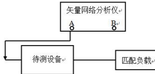
图 20 Input /Output VSWR Test Configuration Diagram
